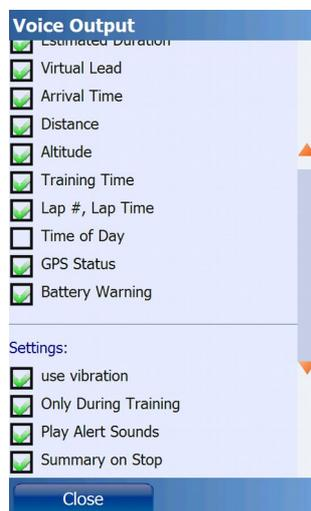
**Vibration verwenden:** das Gerät vibriert wenn Route verlassen wird, beim Intervallwechsel, bei Überschreiten oder Unterschreiten von Herzfrequenz-Vorgaben oder bei schwachem GPS-Signal
