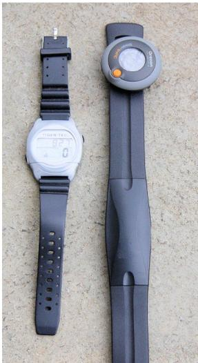
Zum Einschalten des Heart Rate Logger drückt man den orangefarbenen Knopf einmal – zum Ausschalten wird der Knopf für zwei Sekunden gehalten. Nach dem Training verbindet man Datenlogger und PC per USB-Kabel. Die Herzfrequenzmessung wird dann in die mitgelieferte Software „SmartSync“ übernommen.
