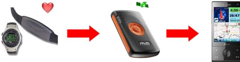
*Verwendung des FRWD B100, um eine Pulsuhr mit Run.GPS zu verbinden*
